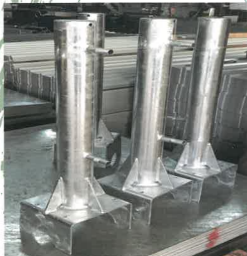
熱鍍鋅燈線柱
